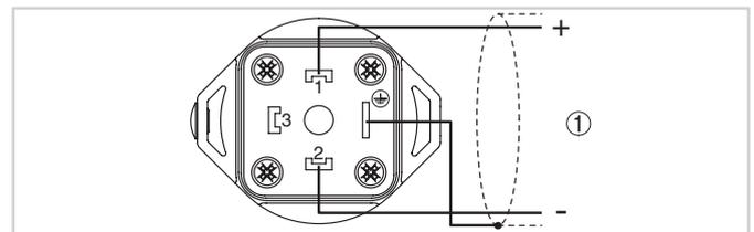
符合 ISO 4400 的接插连接图，仪表侧连接视图
