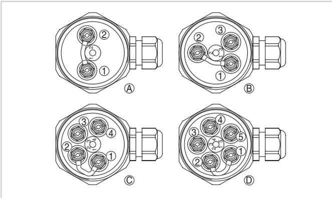
测量探头的连接腔 - 在端子 1 和 2 之间的 220 kΩ 电阻
