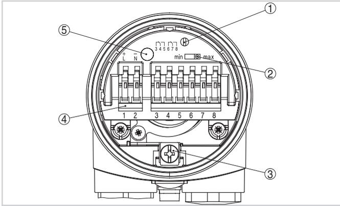
电子部件腔和接线腔 - 继电器输出口
